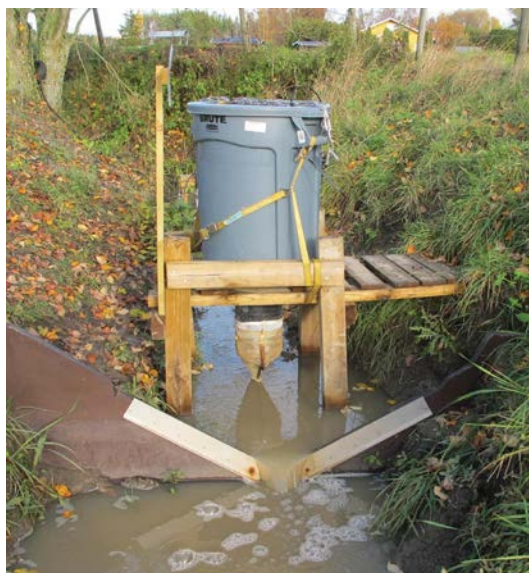
Figur 1 Direktfällningsenhet Foto: TUAS
