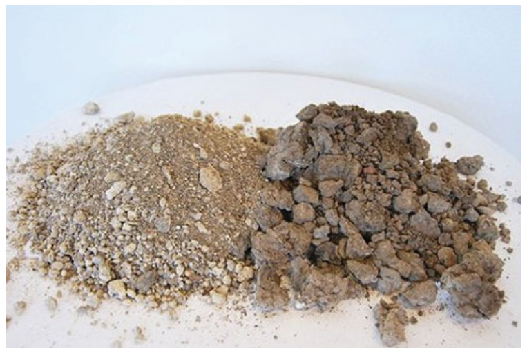
Figur 1 Markens struktur efter och före strukturkalkbehandling. Foto: Nordkalk
